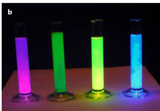
Figura 5. Las probetas contienen luminol en medio básico con diferentes colorantes cromóforos. Al añadir la disolución de ferricianuro de potasio y agua oxigenada, se produce la luminiscencia.
