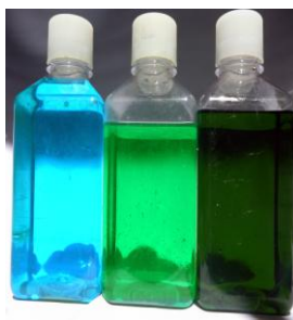
Figura 1. A la izquierda tenemos una solución de sulfato de cobre; al centro, el sulfato salino, apréciase como el color azul del sulfato pasa a un verde al adicionar sal. A la derecha tenemos el sobrenadante del mismo mordente, una vez agotado, luego de trabajar en placa de hierro; el color verde oliva corresponde a cloruro ferroso, el antecedente químico del cloruro férrico, el mordente para cobre.
