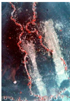
Figura 2. El precipitado rojo que se va depositando sobre las líneas del diseño corresponde a cobre metálico, que se ha reducido a partir del mordente
